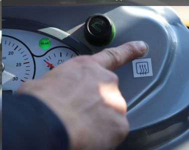
Электрический подогрев заднего стекла
